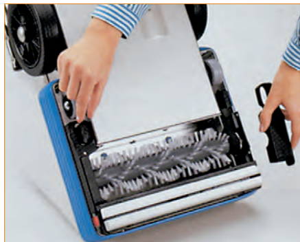
Wechseln der Bürstenwalze
